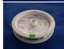
3. Le fil doit être stocké sur les bobines sur lesquelles il a été fourni ; les bandes de support doivent rester sur le fil jusqu'à ce qu'elles soient usées, et remplacées si nécessaire.
