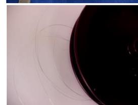
5. Les bobines ne doivent pas être empilées les uns sur les autres pour éviter tout contact entre le fil et la flasque d'une autre bobine.
