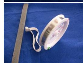
4. Si une bobine est partiellement utilisée, assurez-vous que l'extrémité du fil est correctement attachée de manière sûre. Le fil ne doit jamais être placé sous un autre enroulement car cela peut distordre le fil lors de futures utilisations.
