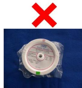
2. Les bobines doivent être conservées en position « de roulement » pour garantir que les couches de fil ne se distordent pas.
